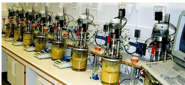
Pilt 1. Kalatoormest rasva ja valgu komponentide eraldamine laboris
