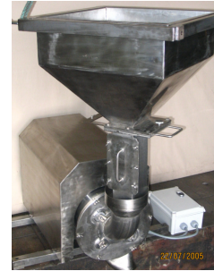
Joonis 3. Pihusti-homogenisaatori skeem, kus 1- töökamber, 2-elektrimootor, 3-rootor, 4-tigutoitja ning pildid masinast ( http://www.desi.ee/ ).
